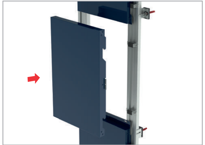
4. Colocación de la nueva bandeja.
